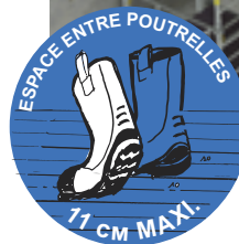
> Pose sans harnais des plaques de contreplaqué grâce au faible espacement de 11 cm entre les secondaires.
