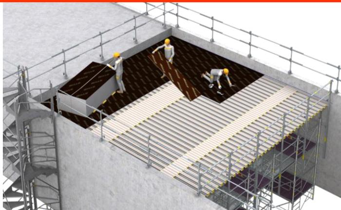
Pour une pose des panneaux en sécurité collective (sans harnais), nous recommandons l'utilisation d'étalement **Touréchaif**, de **poutrelles P11** ou **MP3** et des **garde-corps de coffrage GCC**.
