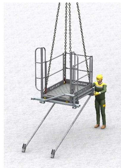
> 3 – Elingage de la passerelle latérale. Pose des bracons à hauteur d'homme avec les boulons M14-100-8.8.
