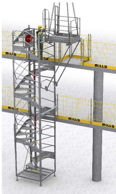
> 4 – Pose de la passerelle latérale sur l'Escalib Mills. Assemblage des bracons sur le 2<sup>ème</sup> Support Passerelle MDS avec les boulons M12-100-8.8. Pose de l'anti-soulèvement et de la passerelle. Désélingage.
