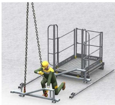
> 1 – Prémontage de la passerelle latérale, avec le Départ et un Support Passerelle MDS. Elingage du 2<sup>ème</sup> support passerelle MDS.
