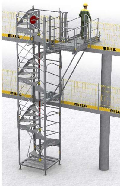
> 5 – Si nécessaire, pose de la passerelle frontale sur la passerelle latérale et boulonnage avec les boulons M12-100-8.8 pour l'anti-soulèvement. Ouverture des garde-corps pour le passage.
