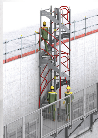
Mini Escalib Mills installé sur une passerelle (PTE).
