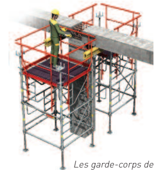
Les garde-corps de clavetage assurent la protection des ouvriers lors des opérations spécifiques de clavetage de poutres.
