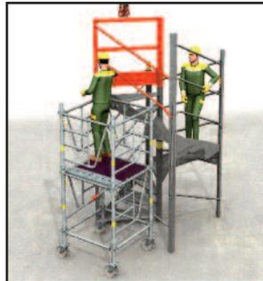
> **3** - Geländer mit dem Kran aufsetzen. Mit M24 Schrauben befestigen. Die 2 Handläufe anbringen. Seilgeschirr abnehmen.
