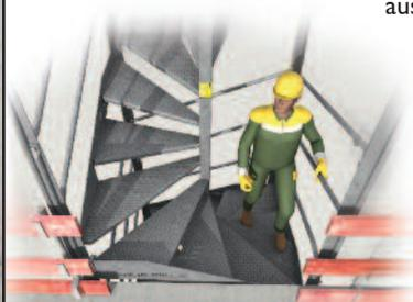
> **10** - Handläufe schwenken, um den Ausstieg bei der gewünschten Ebene zu ermöglichen.
