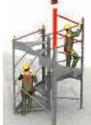
> **7** - Große Pfosten mit dem Kran aufsetzen. Mit M24 Schrauben befestigen. Die 2 Handläufe anbringen. Seilgeschirr abnehmen.
