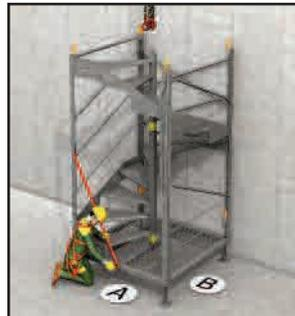
> **3** - Aufsetzen des Standardmoduls auf die Grundplatte und Befestigung der 4 Pfosten mit M24 Schrauben. Seilgeschirr abnehmen. Handläufe vorzugsweise am Haupteingang auf Seite A anbringen
