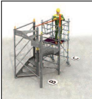
> **1** - Den kleinen Pfosten von einem Rollgerüst aus auf die Ecken der Seite A und B\* setzen. Mit M24 Schrauben befestigen. Handlauf anbringen.
