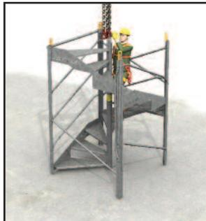
> **2** - Zugang im Standard-Modul zum Aufhängen des Seilgeschirrs in den Mittelring.
