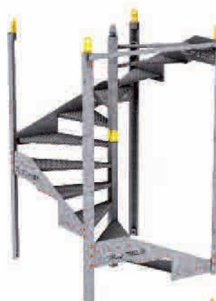
② - Das aufgebaute Modul muss noch mit Geländer- Handläufen ausgestattet werden (rot dargestellte Bolzen).
