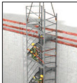
> **10** - Die 3 Handläufe mit Hilfe eines zweiten Monteurs zwischen den 2 Modulen anbringen.
