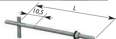
One-shoot ermöglicht eine Befestigung in den Bohrungen der Betonschalungen mit 2 Escalib Mills Schellen.
