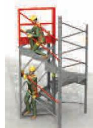
> **8** - Geländer mit dem Kran aufsetzen. Mit M24 Schrauben befestigen. Die 2 Handläufe anbringen. Kranhaken auf die 4 Hubringe anschlagen.
