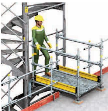
Um den Ausstieg zu erleichtern, kann ein Laufsteg durch Zusammensetzen unserer Mills Acram Gerüstkomponenten auf die Wangen der Escalib Mills Treppe mit Hilfe von 2 Laufstegträger (links und rechts) hergestellt werden. Letztere werden mit einem 1,50 m langen Gerüstrohr oben bzw. unten, je nach Höhe der zu erreichenden Stufe, verbunden.
