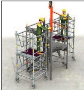
> **2** - Den großen Pfosten mit dem Kran aufsetzen. Mit M24 befestigen. Die 2 Handläufe anbringen. Seilgeschirr abnehmen.
