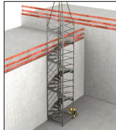
> **3** - Escalib Mills auf den Boden absetzen und waagrecht ausrichten.
