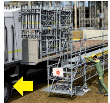
Lorsque le véhicule est stationné, déplacez le quai contre la remorque, puis serrez les freins. Seules 2 surfaces de roulement suffisent. Ces surfaces doivent être horizontales.
