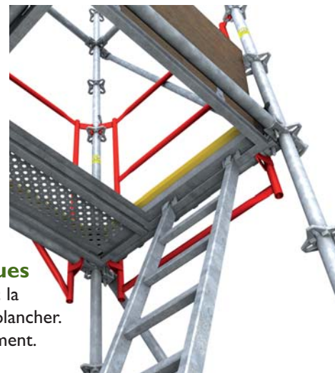
Vue de détail de l'emboîtement du garde-corps et de son verrouillage avec la lisse plancher.
